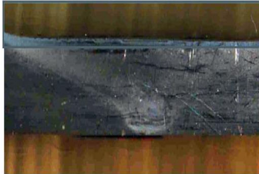
Figura 2. 40 Pieza soldada con el proceso FSW de una aleación AL-Cu-Li 2198 [37].
