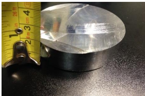
Figura 6.1. Muestra de acero H13 (antes de pulir).
