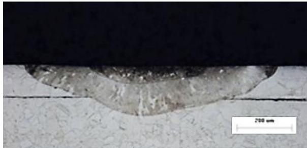
**Figura 2-16:** Sección transversal de una soldadura en modo de conducción láser pulsada Nd: YAG [35].
