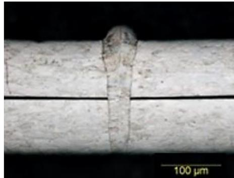
**Figura 2-17:** Sección transversal de una soldadura en modo penetración de onda continua [35].
