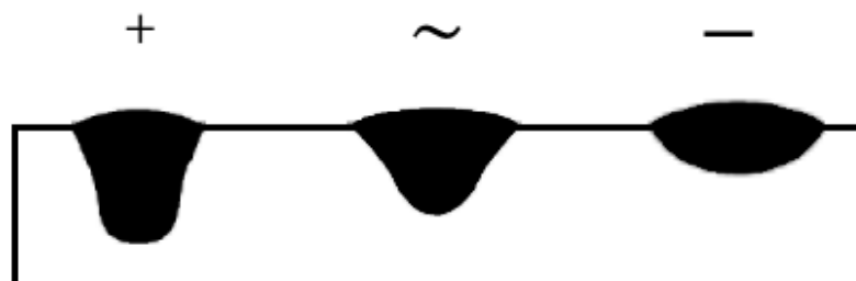
Figura 2.8 Efecto de la polaridad en una soldadura [23].
