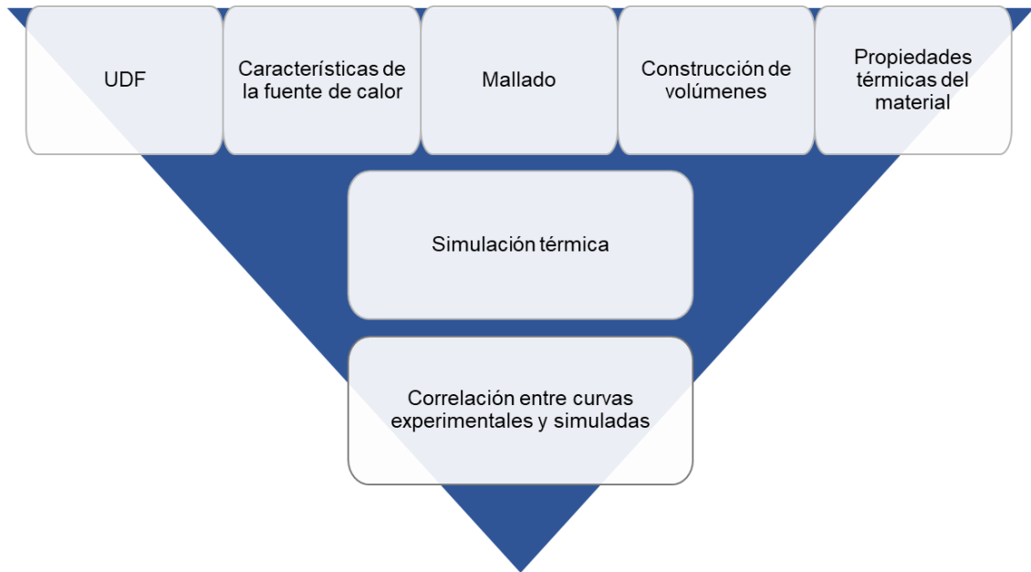
Figura 4.7 Esquema de trabajo utilizado en el proceso de simulación.
