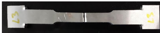
Figura 5. 8. Resultados del ensayo de tracción para LBW. a) Curva representa carga aplicada vs deformación, b) ruptura de la probeta traccionada.
