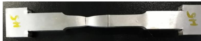
Figura 5. 7. Resultados del ensayo de tracción para HLAW. a) Curva representa carga aplicada vs deformación, b) ruptura de la probeta traccionada.
