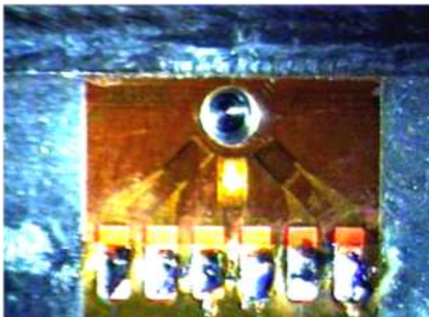
Figura 2.26. Galga extensométrica con barreno utilizada para realizar mediciones de deformaciones a 45°, en la zona afectada por el calor (13).
