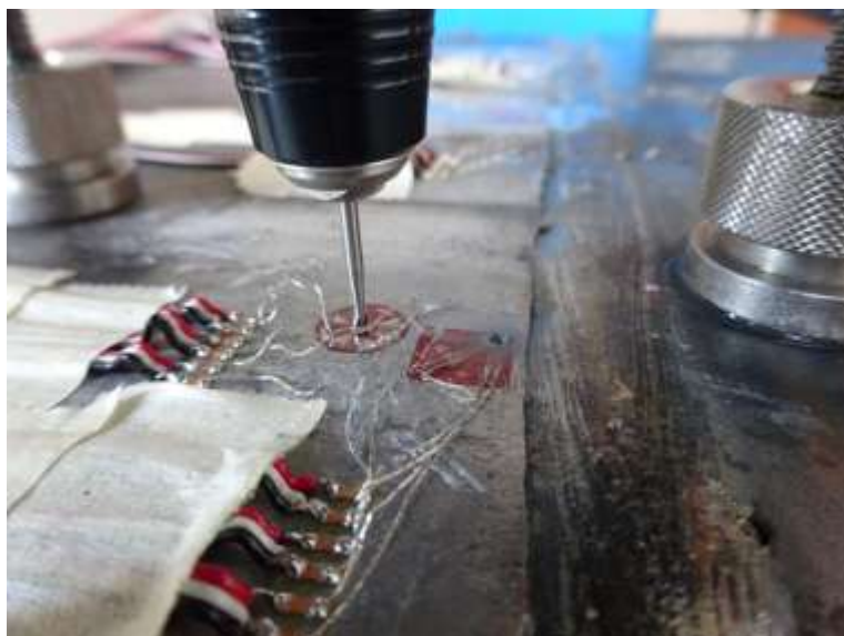
Figura 4.13. Taladro RS-200 de funcionamiento con flujo de aire comprimido para el método del barreno según el estándar ASTM E837-08.
