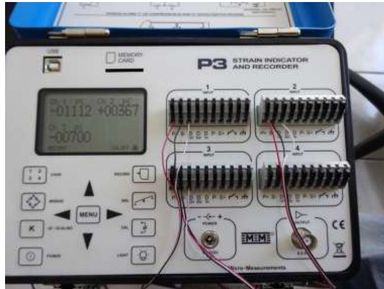
Figura 4.12. Dispositivo indicador de medición y registro de microdeformaciones, con cuatro canales, modelo P3, de la marca Micro-Measurements.
