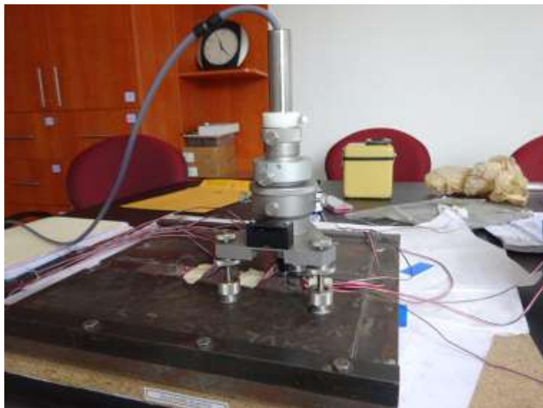
Figura 4.13. Taladro RS-200 de funcionamiento con flujo de aire comprimido para el método del barreno según el estándar ASTM E837-08.
