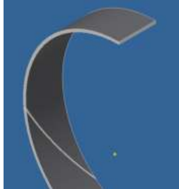
Figura 5.29. Segmento de circunferencia graficado en SYSWELD (51) en tubería de 36 pulgadas de diámetro con acero API X70 y soldadura helicoidal.
