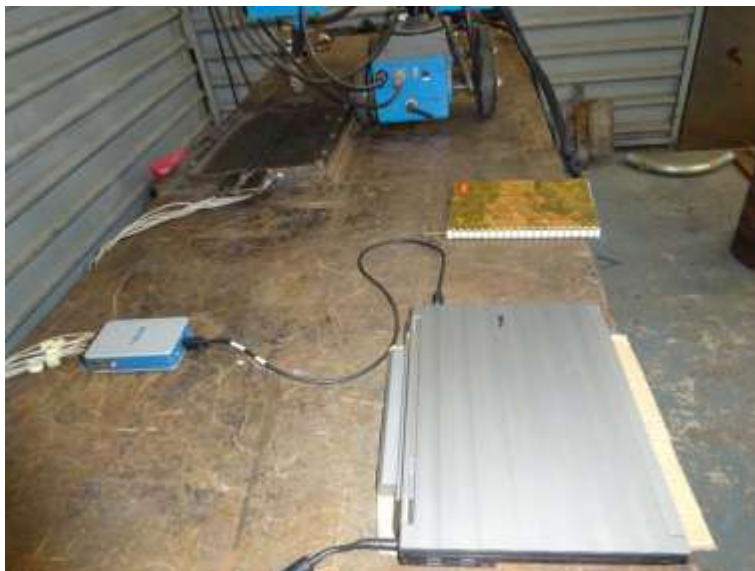
Figura 4.10. Fotografía del equipo utilizado para la medición de temperaturas mediante el uso de termopares, una tarjeta de adquisición de datos marca National Instruments, que se muestra a la izquierda y una computadora tipo portátil a la derecha de la fotografía.
