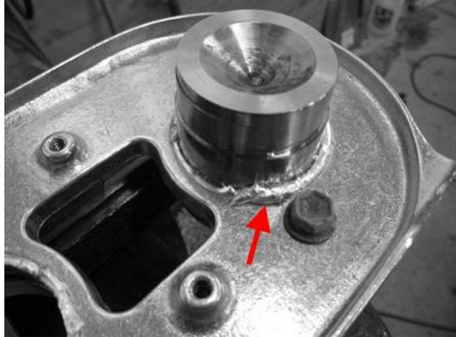
Figura 2.13 Discontinuidad en los filetes es una pieza de aluminio soldada por brazing [25].
