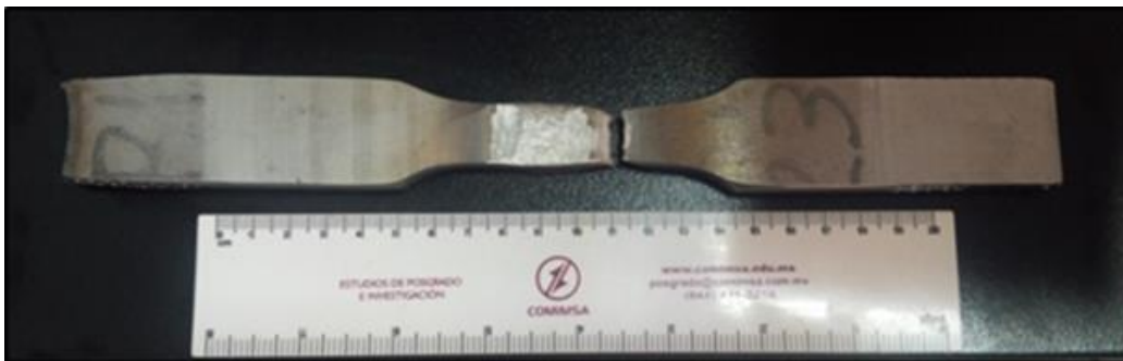
Figura 3. 8 Probeta de tensión de DSS 2205 unida mediante GTAW con ruptura en MB.
