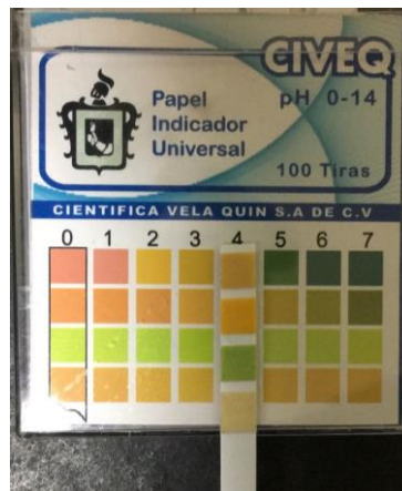
Figura 3. 20 Medición del pH al inicio de la prueba
