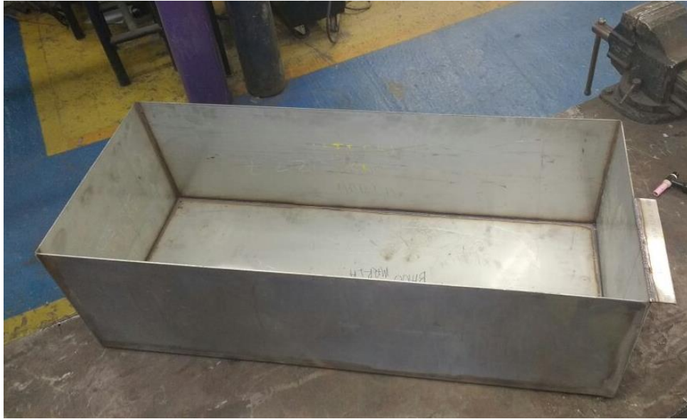
Figura 3. 18 Baño María del Sistema de Calentamiento del Reactor de Corrosión
