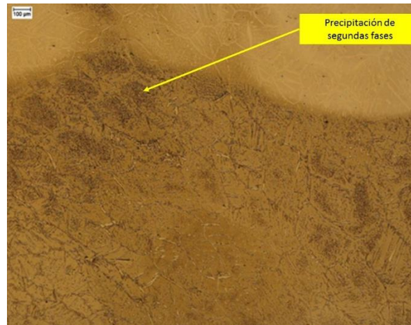
Figura 4. 9 Precipitación de segundas fases en Probeta a 500 hrs y a 120% límite elástico del material
