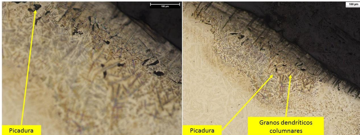
Figura 4. 13 Microestructuras en Probetas a 80% límite elástico a 610 hrs de exposición a SCC
