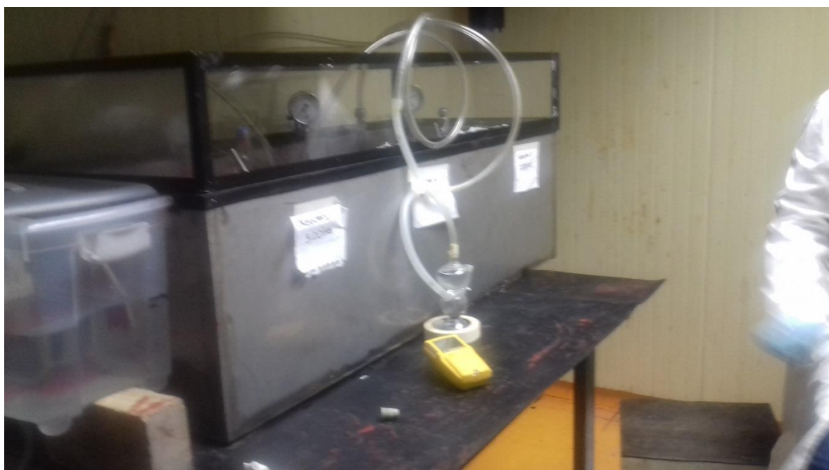
Figura 3. 15 Reactor de corrosión instalado con todos sus elementos de operación
