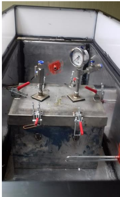
Figura 3. 19 Detalle del interior del Baño María, cámara de reacción y resistencia eléctrica
