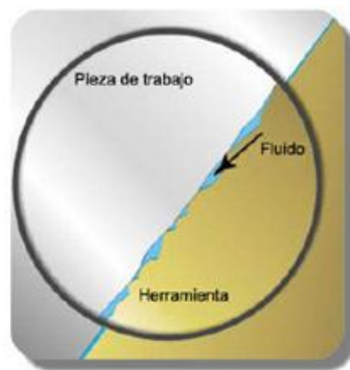
Figura 6.7: Fluido de corte eliminando el calor del rozamiento entre la herramienta y la pieza de trabajo
