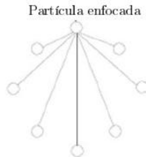
Figura 4.5: La gráfica de todo conectado representa la topología de vecindad con conexión completa (cada círculo representa una partícula). Todos los miembros del cúmulo están conectados entre sí
