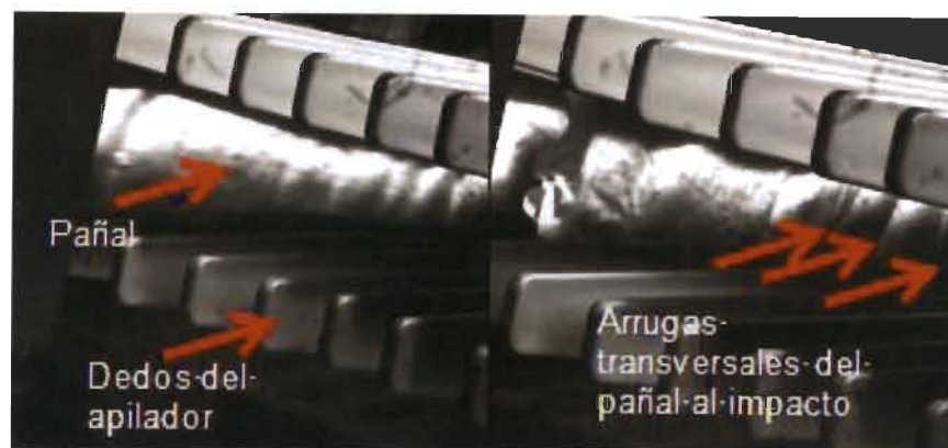
Figura 3. Arrugas transversales debido al choque del pañal contra la cadena de dedos receptores en la máquina Stacker.
