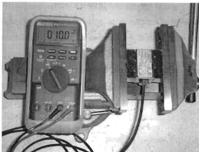
FIGURA 3.12 Generación de salida de 10 mV en celda de carga.
