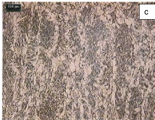
c) Soldadura. Brazos columnares de ferrita solidificación de soldadura 50X, Nital 5%
