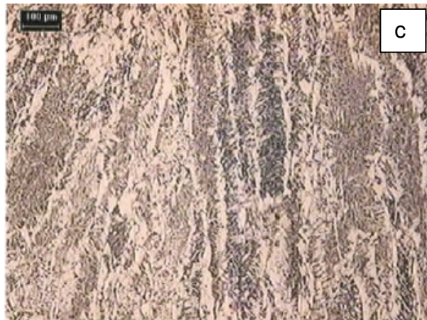
c) Soldadura. Brazos columnares de ferrita solidificación de soldadura 50X, Nital 5%
