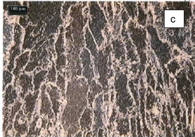
c) Soldadura. Brazos columnares de ferrita solidificación de soldadura 50X, Nital 5%
