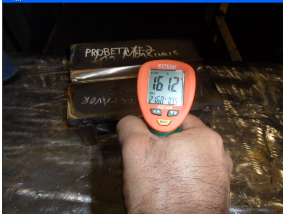
Figura 3.6 Medición de la temperatura de pre calentamiento por medio de pirómetro láser. Cortesía Equipos de Acuña
