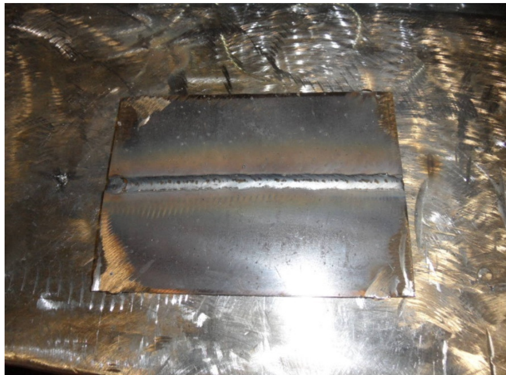
Figura 3.10 Cordón de soldadura aplicado en la preparación del saneo de la probeta Cortesía Equipos de Acuña
