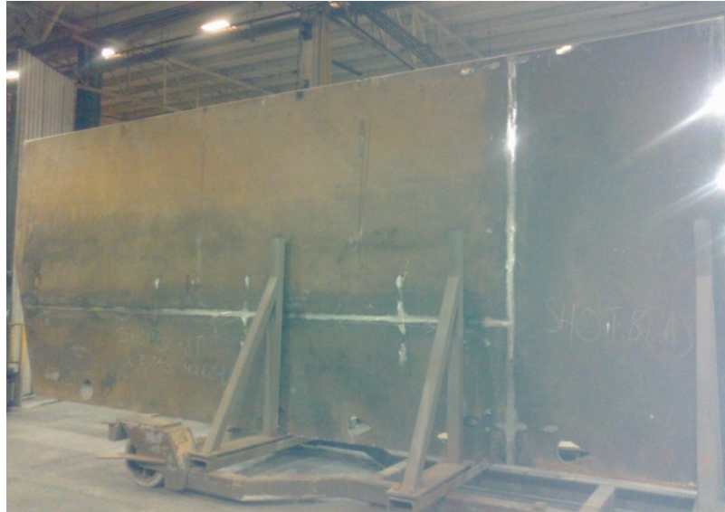
Figura 3.1. Piso de la caja del camión unido por el proceso GMAW en acero HSLA templado y revenido cortesía Equipos de Acuña
