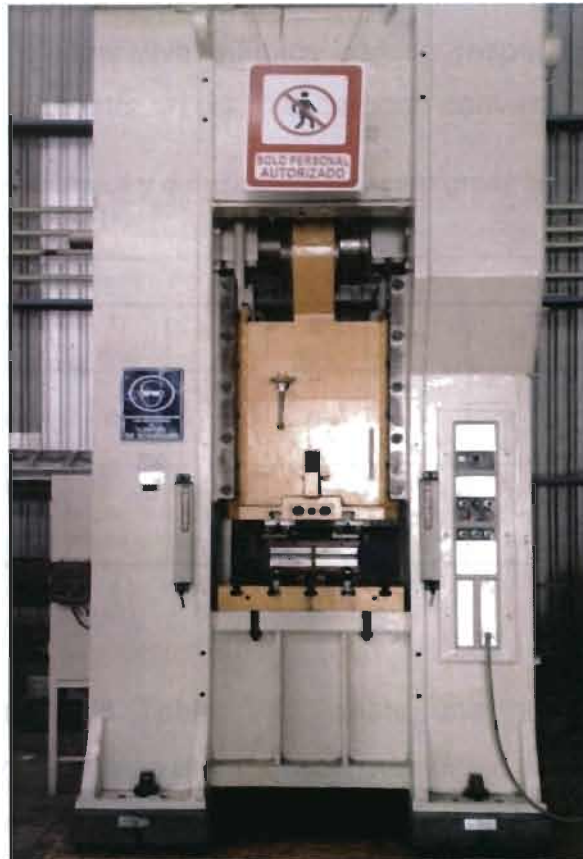
Figura 1. 1Prensa de 250 Ton de carga para conformado de piezas (Cortesía COMIMSA)
