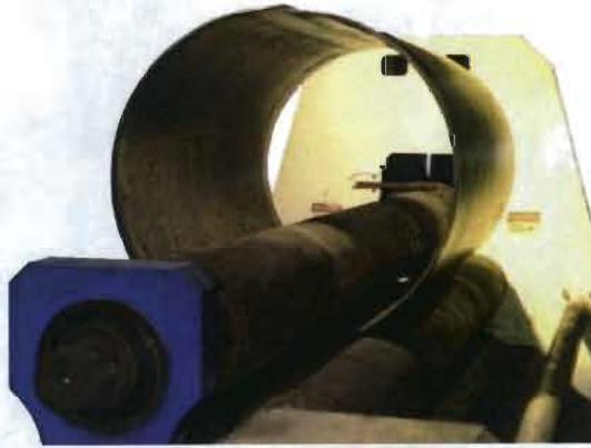
Figura 2. 7 Roladora con rodillos de acero D2 para moldeo de tubería (13)
