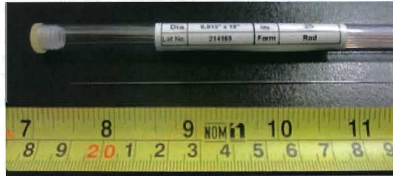
Figura 4. 2 Metal de aporte utilizado para micro laser cladding (Cortesía COMIMSA)
