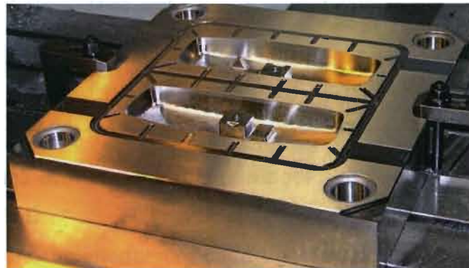
Figura 2. 4 Maquinado de plantilla por CNC de un acero grado herramienta con el cual posteriormente se utilizara como plantilla (7)
