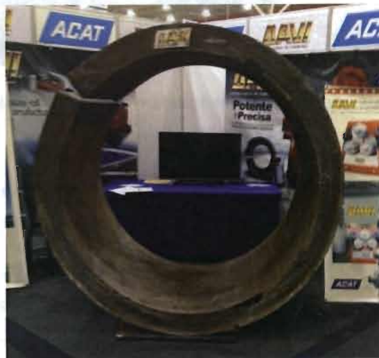
Figura 2. 8 Tubería con espesor de 127 mm, rolada por aceros D2 (Cortesía COMIMSA)
