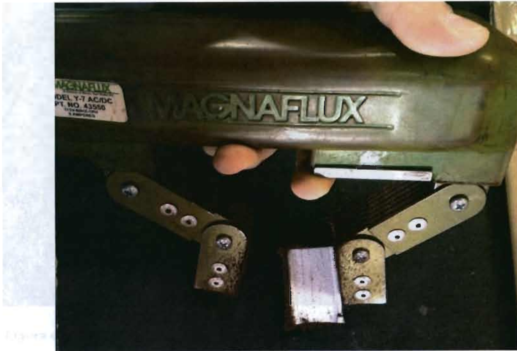
Figura 4. 5 Inspección mediante partículas magnéticas secas visibles con yugo electromagnético
