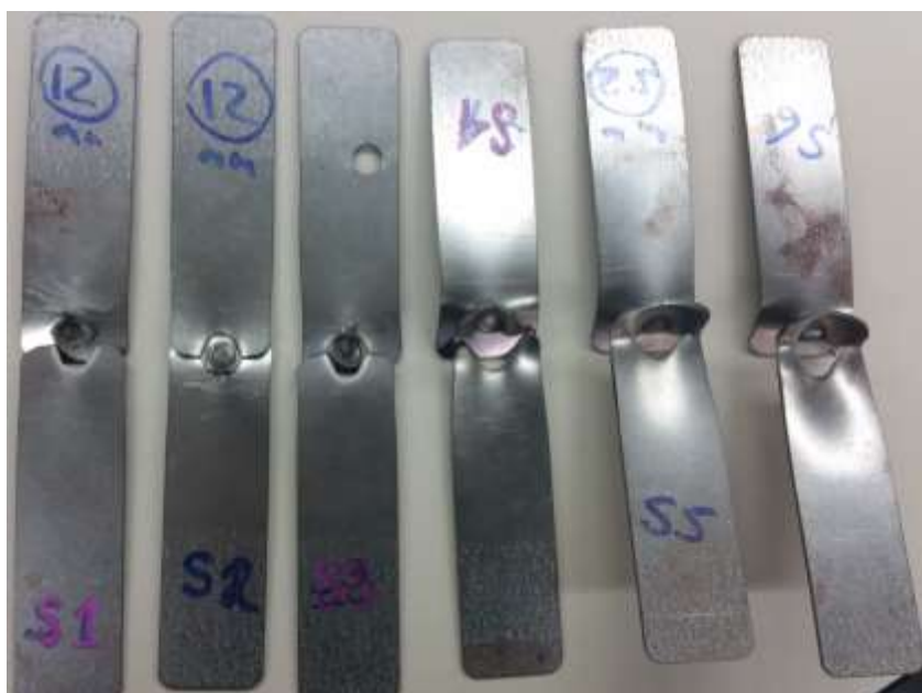
Figura 4.19: Probetas de soldadura por resistencia después de prueba de tensión a esfuerzo cortante
