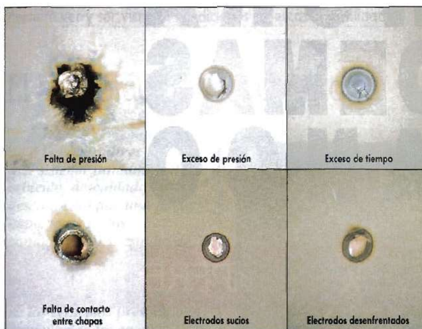
Figura 2.9 Defectos de soldadura comunes en soldadura por resistencia. (Peña, 2009).
