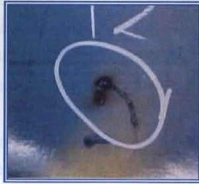
Figura 2.11. Ejemplo de un golpe de arco [6]
