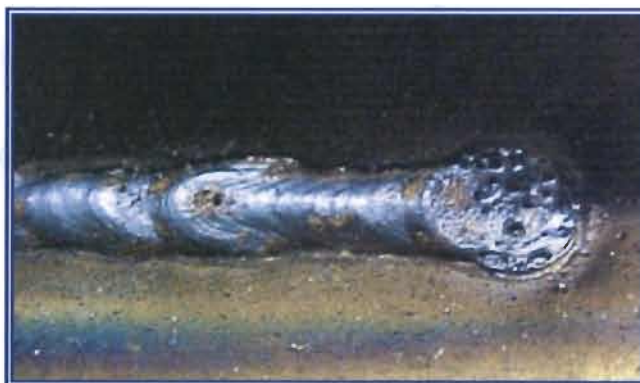
Figura 2.15 Porosidad en soldadura [21]
