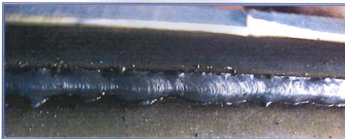
Figura 2.21 Falta de fusión [21]
