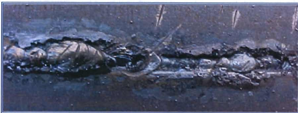
Figura 2.22, Falta de penetración [21]
