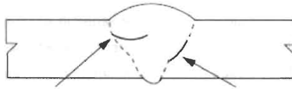
Traslape frío entre cordones y Traslape frío entre el cordón de soldadura y el material base Figura 2.9. Fusión incompleta debida a traslape (IFD)
