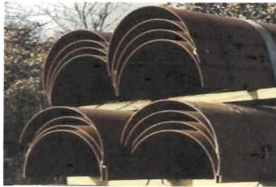
Figura 2.10. Las camisas metálicas, generalmente se fabrican a partir de 2 medias cañas, con material igual al grado del tubo a reparar o grado superior [13]
