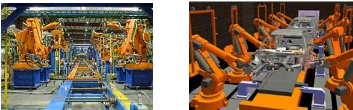
Fig. 2.21 Ejemplo de programación fuera de línea para producción de chasis Volvo.
