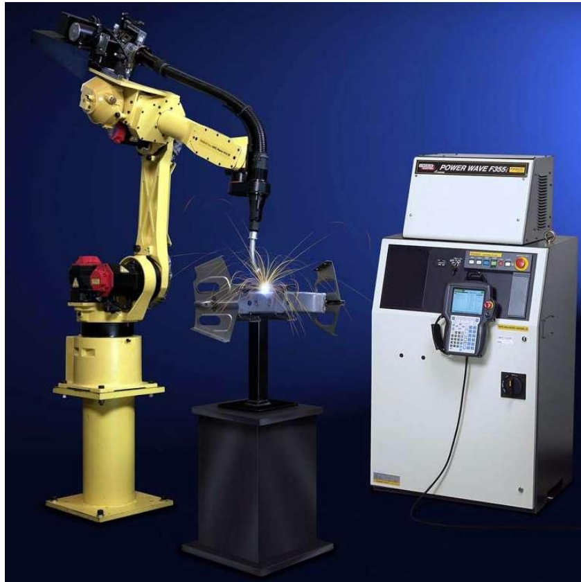
Fig. 2.18 Robot Soldador con equipo de control.
