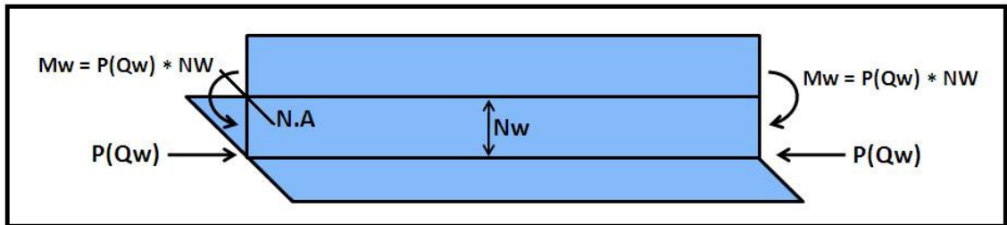
Figura 9. Momento de soldadura en una viga formada [3]
