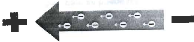
Figura 2. Viaje de las cargas negativas en un circuito hacia el polo positivo.
