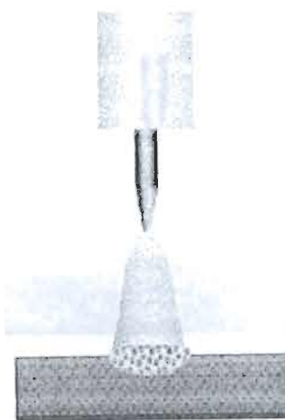
Figura 6 Perfil de penetración del Helio es más ancho pero menos profundo que el del Argón.
