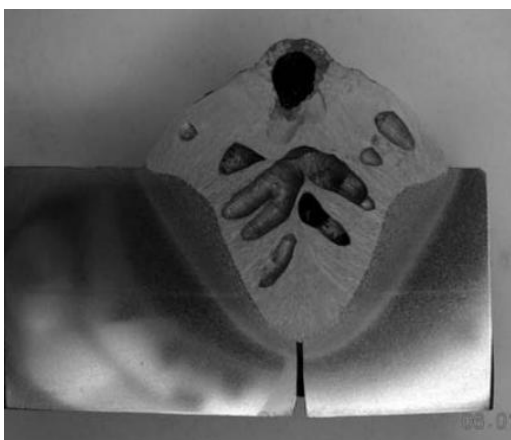
Figura 2.13. Porosidad en soldadura por arco sumergido en acero ASTM A709. [25]
