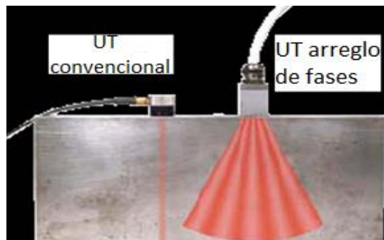
Figura 2.18 Comparación ultrasonido b) arreglo de fases con a) ultrasonido convencional. [13].
