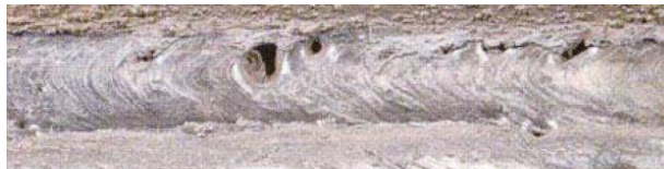
Figura 2.10 Escoria atrapada en la soldadura. [19].
