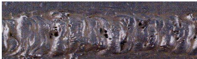
Figura 2.6 Porosidad distribuida uniformemente en la soldadura. [19.]
