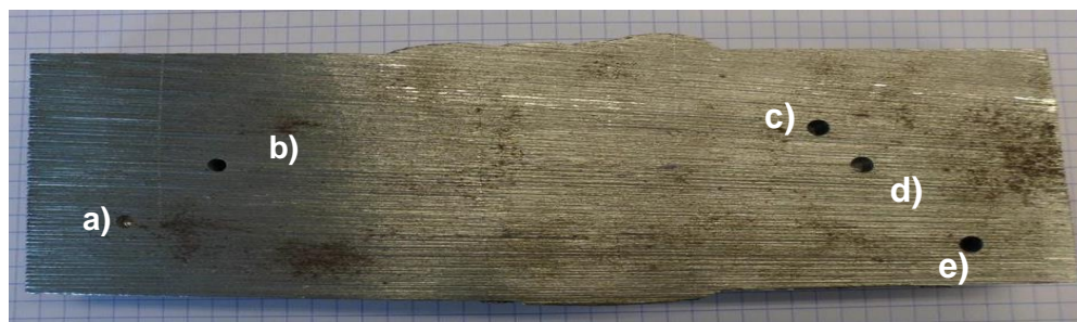
Figura 4.11 Pieza con defectos inducidos y detectados.
