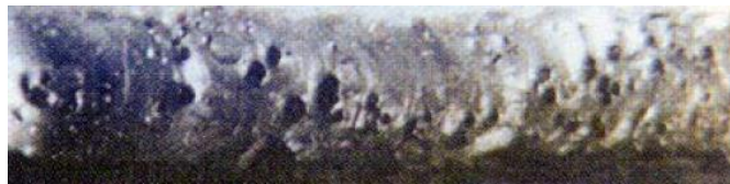
Figura 2.7 Un tipo de discontinuidad de poros agrupados. [19].
