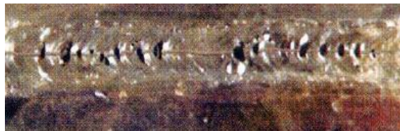
Figura 2.8 Discontinuidad tipo poros alineados. [19].
