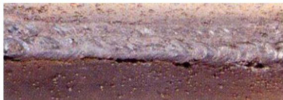
Figura 2.9 Discontinuidad tipo socavado. [2].
