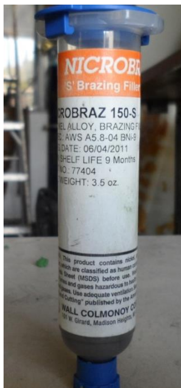
Figura 4.2 Pasta Nicrobraz 150-S (AWS A5.8-04 BNi-9) usado para soldar álabes de turbina base níquel por el proceso brazing
