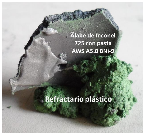
Figura 4.4 Álabe con pasta para brazing colocada sobre barro refractario plástico antes de iniciar el proceso
