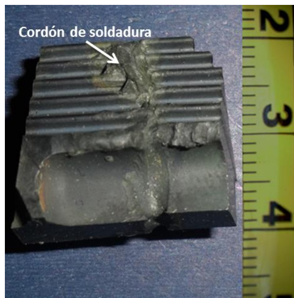
Figura 5.12 Imagen de muestra de álabe de INCONEL 725 unido por el proceso brazing a 1200 °C por 2 h
