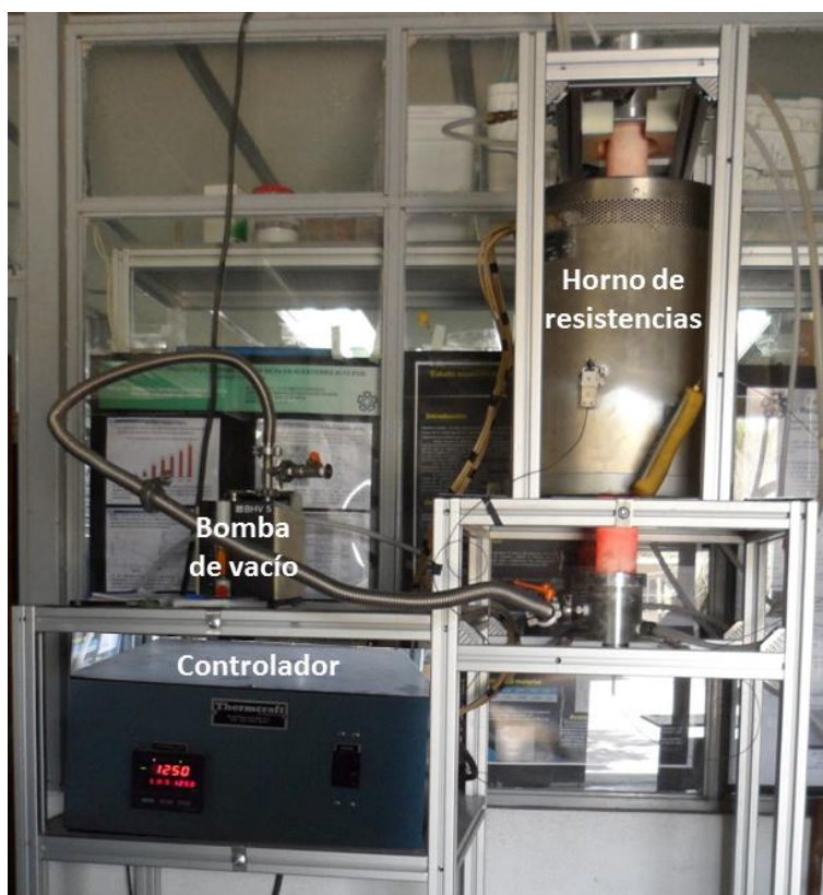
Figura 4.3 Acondicionamiento del horno de resistencias para aplicación del proceso brazing
