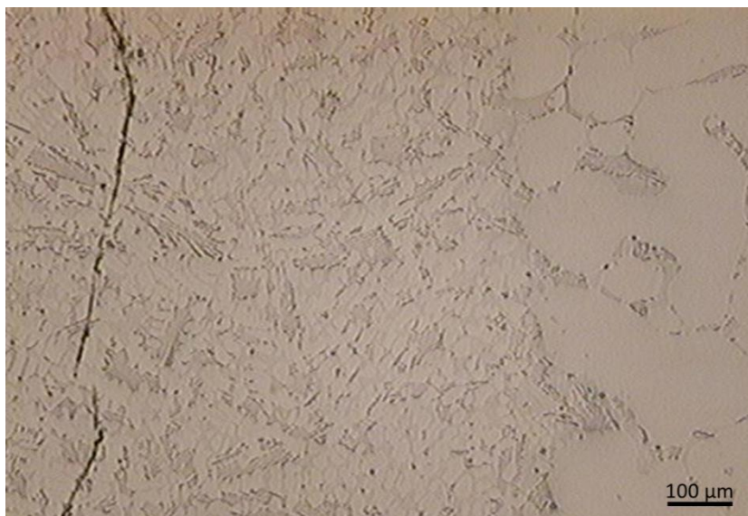
Figura 5.14 Micrografía en condición de pulido de una muestra de álabe reparada por brazing a 1200 °C durante 2 h usando nanopartículas de W sobre la superficie de fractura
