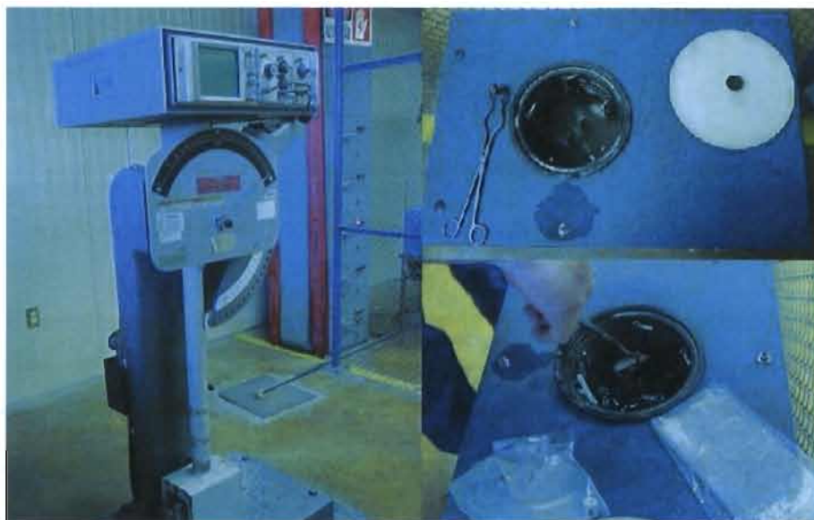
Figura 3.3 Máquina de pruebas de impacto con temperatura controlada.
