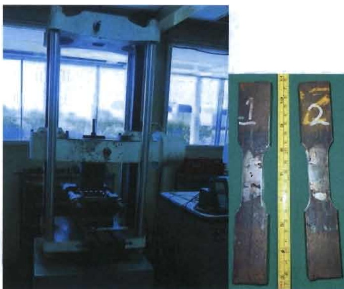
Figura 3.2 Máquina de tensión marca TINIUS-OLSEN y probetas de realizadas a partir de las secciones de tubería API 5L X 52
