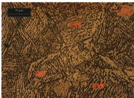
Figura 4.10 Micrografía obtenida a 200X de la probeta S17 cuyo constituyente principal es ferrita Widmanstätten (FW) y ferrita alotriomórfica (FA).
