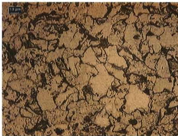
Figura 4.9 Micrografía obtenida a 500X de la probeta S17 constituida por ferrita equiaxial y perlita.
