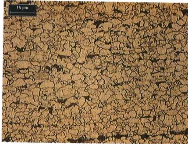
Figura 4.11 Micrografía obtenida a 500X de la probeta S17 cuyo principal constituyente es ferrita equiaxial con trazas de perlita.
