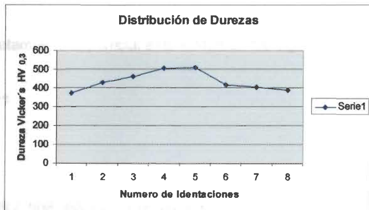
Gráfica 13.- Distribución de microdurezas en prueba 4. (En Hv con 0.3kg de carga).
