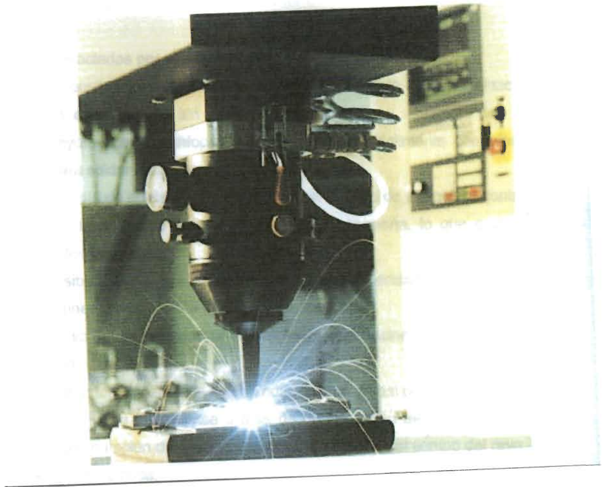
Figura 5.1.- Proceso de soldadura por rayo láser (LBW)
