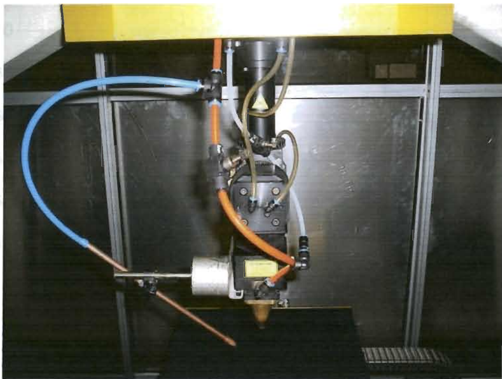
Figura 5.26.- Equipo láser CO 2 con una potencia de 6Kw.
