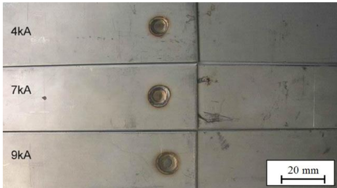
Figura 2.39. Uniones de RSW a distintos valores de corriente. [22]
