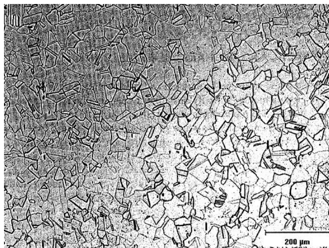
Figura 2.10. Microestructura AISI 304 austenítico. [3]
