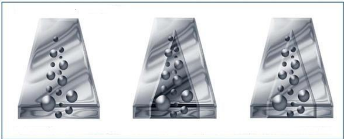
Figura 2.1. Película de óxido de cromo. El oxígeno del medio crea una capa protectora de óxido de cromo en el acero inoxidable. [2]
