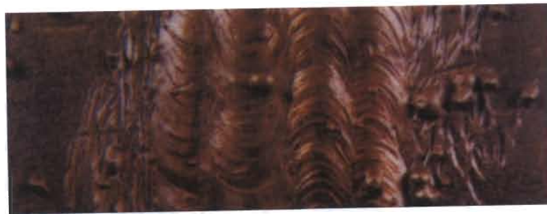
Figura 5.13 Chisporroteo en el cordón de soldadura
