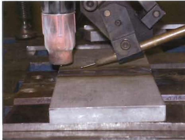
Figura 6.11 Modo de alimentación del material de aporte
