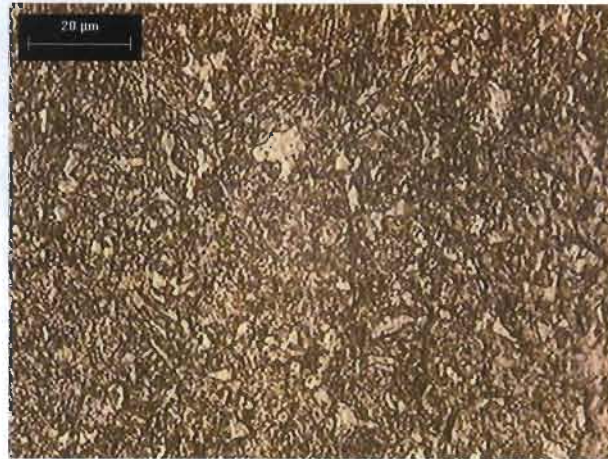
Figura 7.7 Metal base muestra A (no precalentada) 500X
