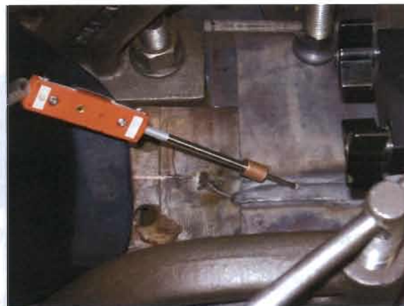
Figura 6.12 Ilustración de la colocación del termopar
