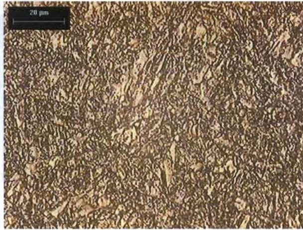
Figura 7.11 Metal base muestra B (precalentada) 500X
