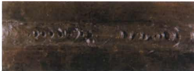
Figura 5.9 Porosidad alineada en una unión soldada
