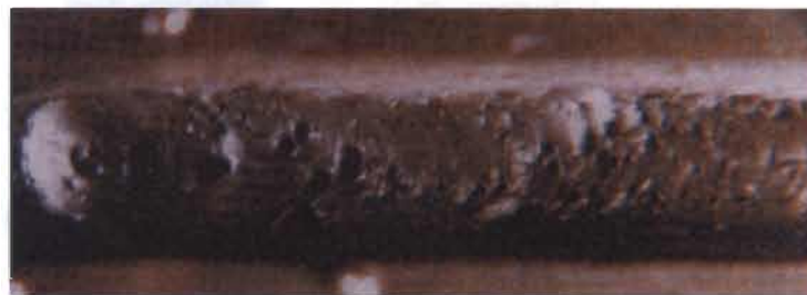
Figura 5.7 Porosidad dispersa en una unión soldada
