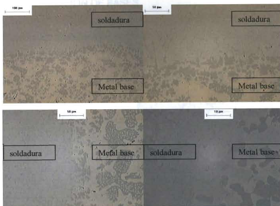
Figura 12. Interfase tomada a magnificaciones de 100X, 200X, 500X, 1000X respectivamente en la cual se observa una estrecha zona afectada por el calor.
