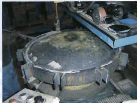
Figura 14. Posición vertical del electrodo durante el ensamble de la tapa y el cuerpo.
