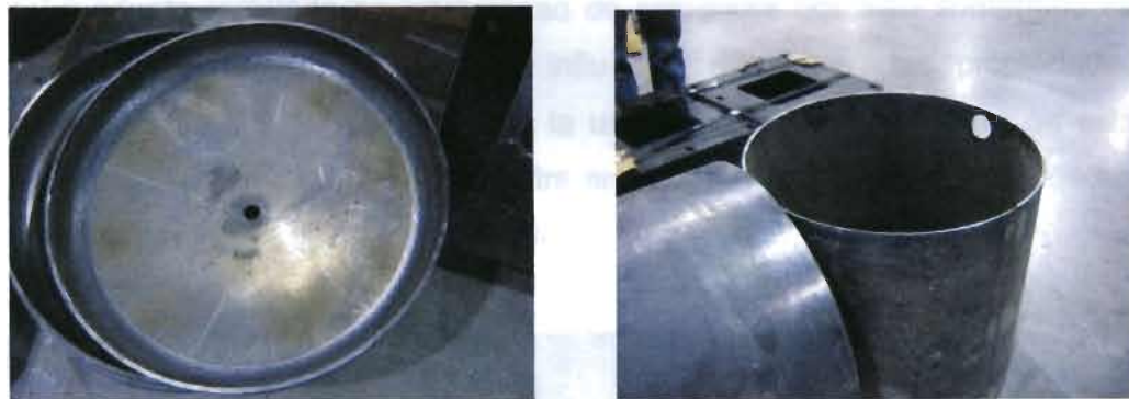
Figuras 12 y 13. Tapa y cuerpo del filtro, antes del ensamble. (Cortesía de Camfilfar)
