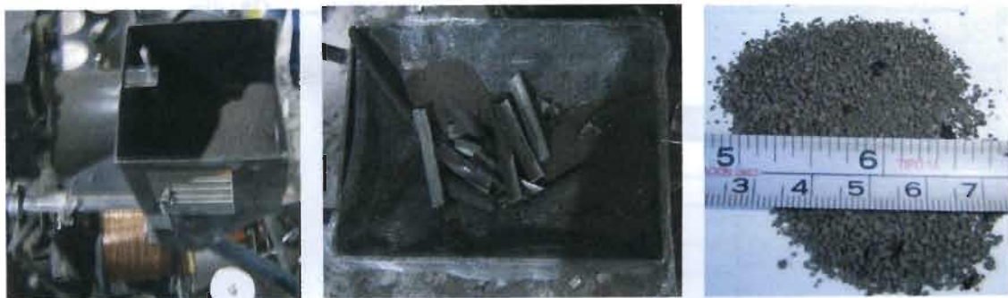
Figura 16. a) Tolva de fundente abierta a la atmósfera, b) tolva de recicle de fundente granulado y cascarilla sinterizada y c) muestra del fundente reciclado, nótese las partículas quemadas de color oscuro. (Cortesía de Camfilfar)
