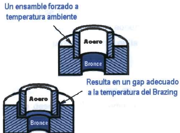
Figura 5. Separación holgada en uniones por brazing.
