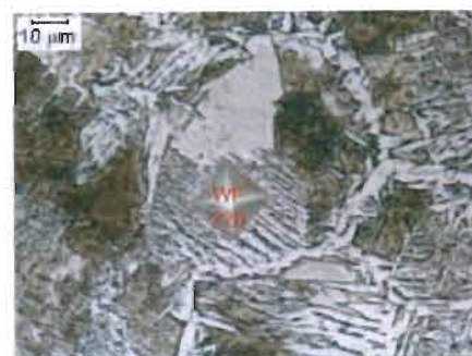
b) Secuencia típica de transformación en granos pequeños: PF(G) seguida por WF, PF(I) y FC
