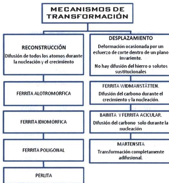
Esquema 2.1 Diagrama de flujo de los mecanismos de transformación en estado sólido presentes en un metal soldado.
