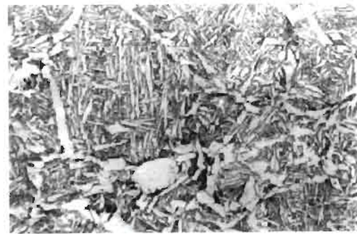
Microestructura a \Delta t_{8/5} = 24 s: PF(G) , FC(P) , PF(I) , FS(A) , FS(NA) . 640X
