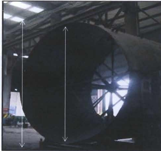
Figura 9. Limitación del diámetro en función al espacio disponible en la planta.
