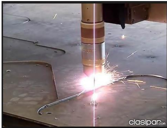
Figura 2. 6 corte por plasma (22)
