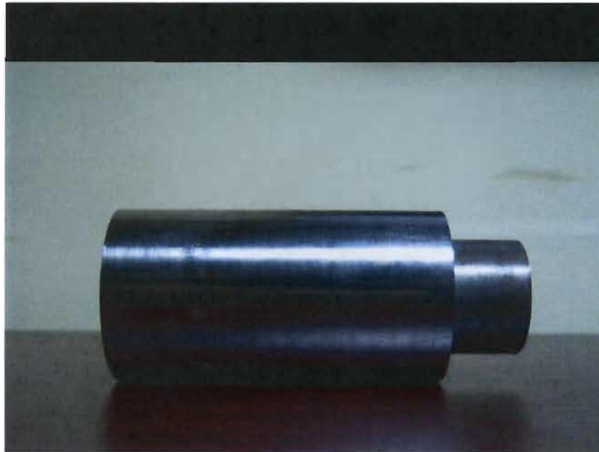
Figura VI. 10 Cilindro a mecanizar compuesto de los tres materiales, aluminio 6062, acero 1018 y acero 4140.
