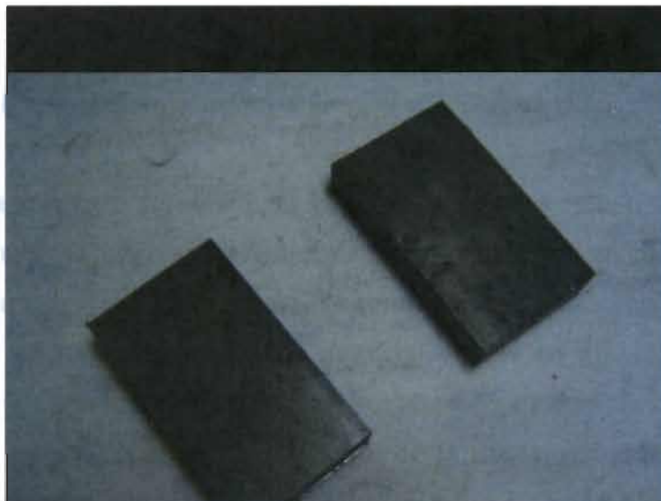
Figura VI. 14 Placas por ser mecanizadas hechas de los tres materiales, aluminio 6062, acero 1018 y del acero 4140.
