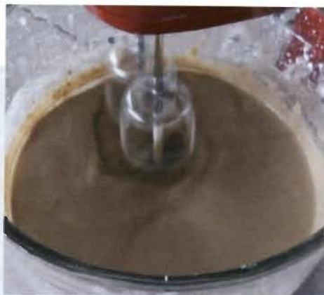
Figura 4.5 Mezcla mecánica e incorporación en la zeolita de las \text{SiO}_2 (NPS)
