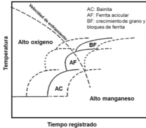
Figura 2. 39 Influencia de los contenidos oxígeno y manganeso en el metal de soldadura sobre la templabilidad del metal de soldadura (41).
