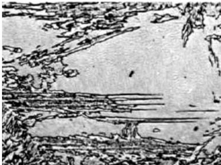
Figura 2. 34 Bainita superior en un acero 4360 transformada a 495 °C, micrografía electrónica de barrido (46).
