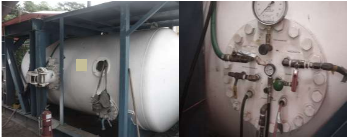
Figura 4. 2 Cámara hiperbárica presurizada con capacidad de 300 m de profundidad, desarrollada para realizar soldadura húmeda, Cd. Del Carmen, Campeche, México.
