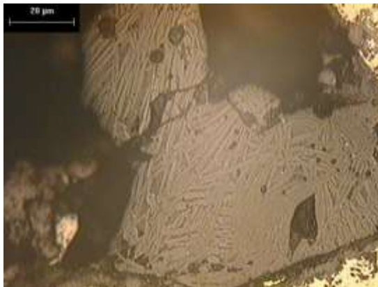
Figura 4. 15 Inclusión de escoria vista a 50X, en la probeta de 40 m.
