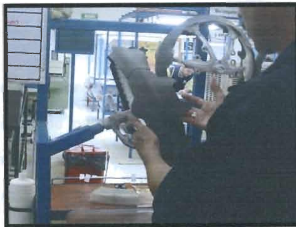
Fig. 5.13 Imagen de la Colocación de Pegamento en el Volante
