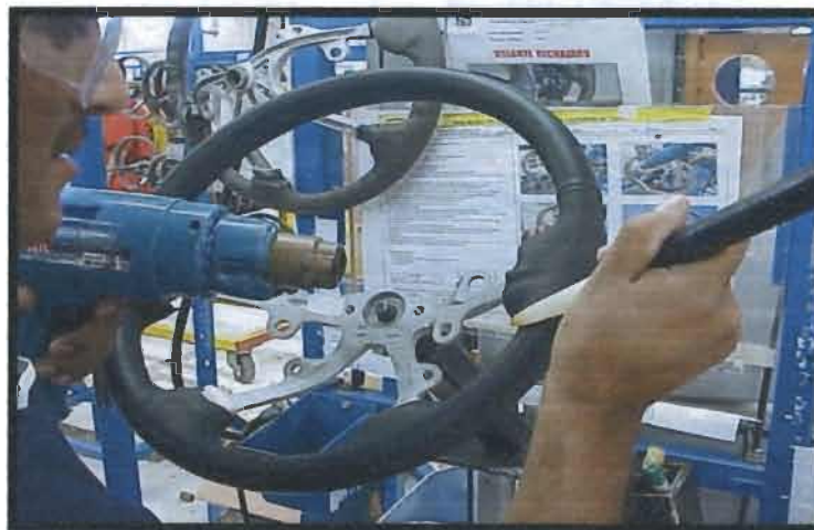
5.15 Imagen de la Aplicación de Vapor
