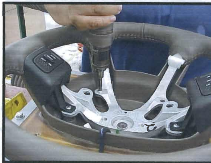
5.17 Imagen del Ensamble de la Cubierta con el Volante
