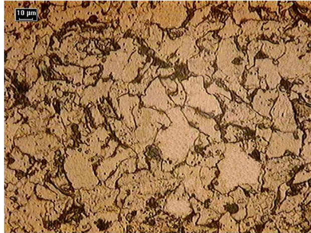
Figura 4.9 Micrografía obtenida a 500X de la probeta S17 constituida por ferrita equiaxial y perlita.
