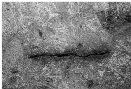
Figura 2.16 Micrografía de una grieta en frío con una estructura bainítica de la zona afectada por el calor. [18]
