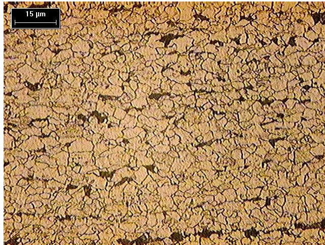
Figura 4.11 Micrografía obtenida a 500X de la probeta S17 cuyo principal constituyente es ferrita equiaxial con trazas de perlita.
