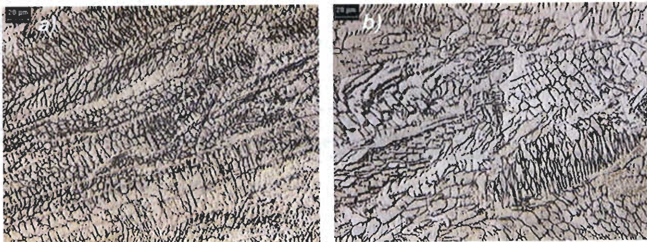
Figura 4.16. Metalografía de las muestras de la segunda etapa a 200X a) Vel. 365.76 m/h 8% H. b) Vel. 350.52 m/h 8 %H.
