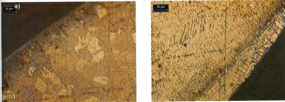
Figura 4.27. Microestructuras de la muestra # 3 a) Metal base a 200X. b) Soldadura a 50X.
