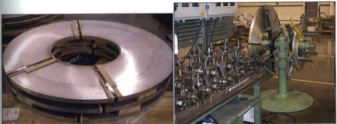
Figura 2.16. a) Materia prima. b) Etapa de deformación del material (Tubos Samuel S.A de C.V.).
