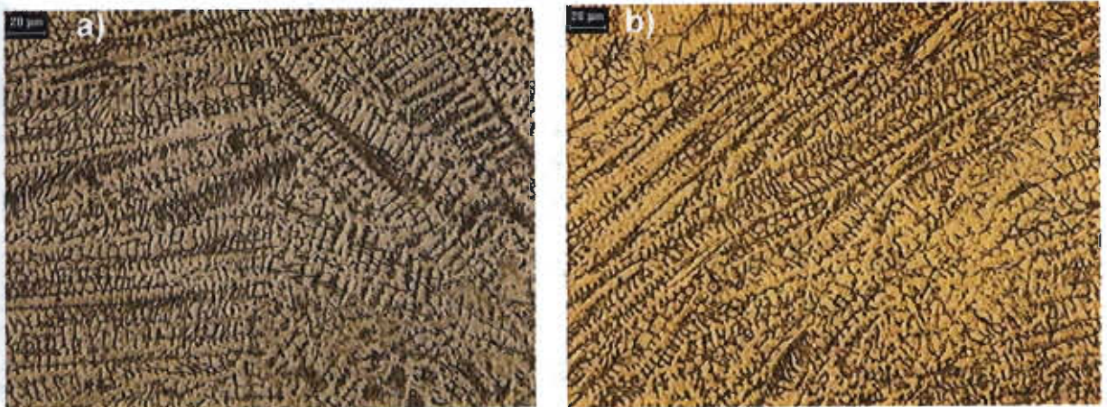
Figura 4.1. Metalografía de las muestras 200X a) Vel. 335.28 m/h 0% H. b) Vel. 365.76 m/h 0 % H.
