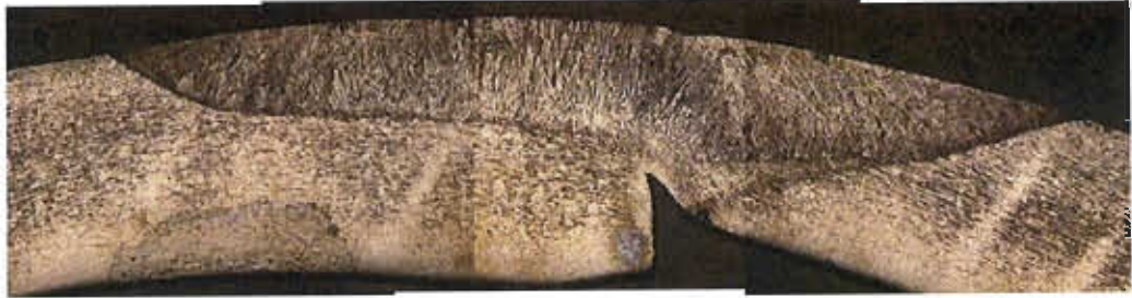
Figura 4.7. Perfil metalográfico de la muestra # 1.
