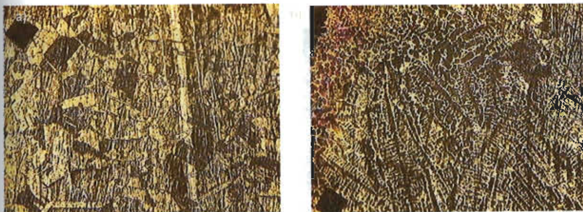
Figura 4.25. Microestructura de la muestra # 6 (sin tratamiento térmico) a) Metal base a 100x. b) Soldadura a 100X.
