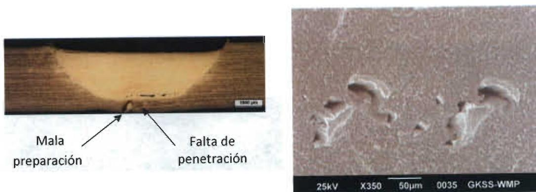
**Figura 40.** Apariencia a altas magnificaciones de la presencia periódica de los defectos que se observan en la macrografía de la unión FSW\_160709-06.
