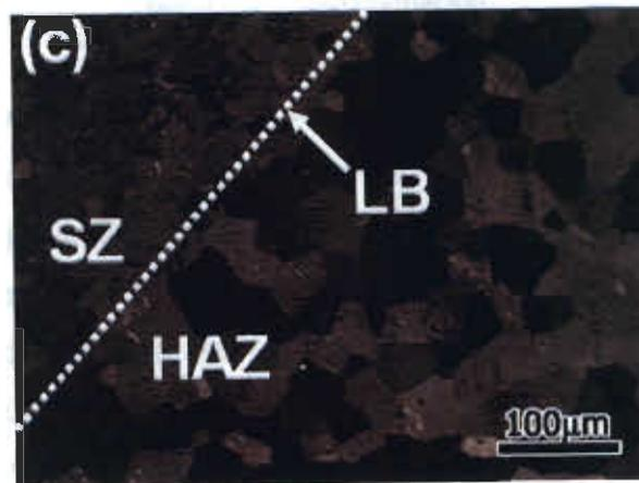
Figura 10. Microestructura  $\alpha$  de una aleación de titanio puro [9].
