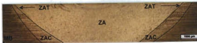
**Figura 26.** Zonas metalúrgicas presentes en una unión Ti-6Al-4V producida mediante el proceso FSW.
