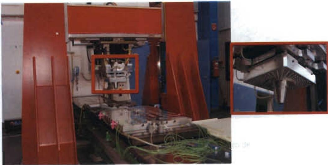
**Figura 16.** Equipo de Soldadura FSW Gantry utilizado en esta investigación, el equipo se encuentra ubicado en el departamento WMP del centro de investigación GKSS.
