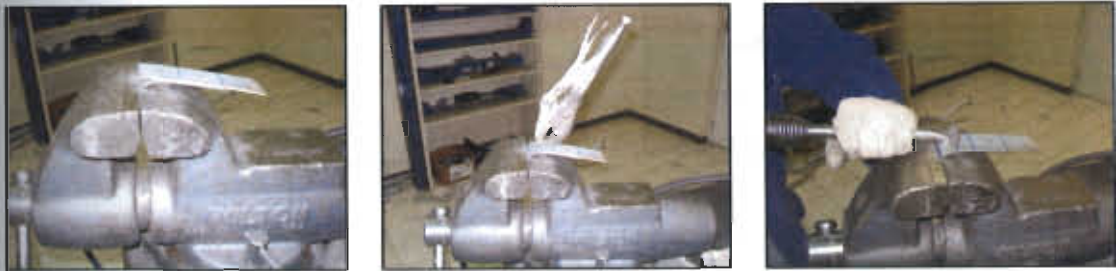
Figura 4.4-1 Prueba de Desprendimiento (Peel Test)
