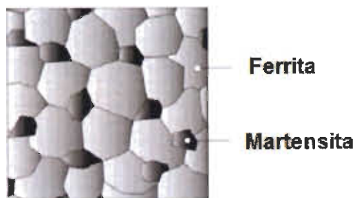
Figura 3.2-1.- Representación esquemática de islas de martensita en una matriz de ferrita. [6]
