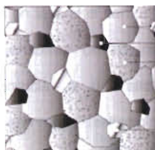
Figura 3.2-4.- Esquema de la microestructura de los aceros TRIP. [9]
