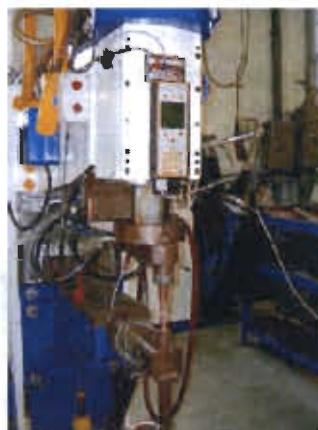
Figura 4.3-3 Equipo de Soldadura de puntos Utilizado
