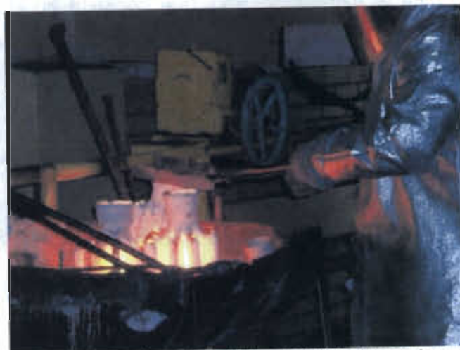
Figura 3.4. Proceso de vaciado del material fundido en los moldes
