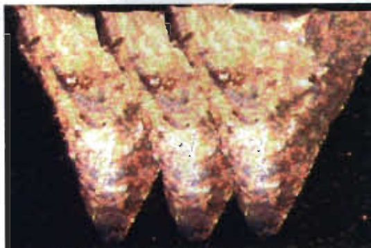
Figura 4.25. Tratamiento superficial de refundido esperado con los parámetros de la muestra 27
