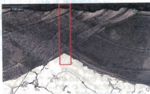
Figura 4.30. Protuberancias en la interface en los traslapes de los barridos con láser
