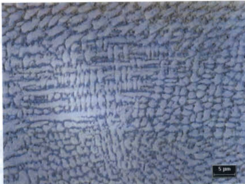
Figura 4.14. Micrografía con el microscopio óptico a 1000x de la fase Co-α (clara)
