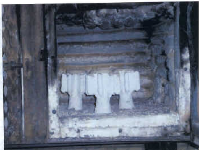
Figura 3.2. Precalentamiento de los moldes cerámicos
