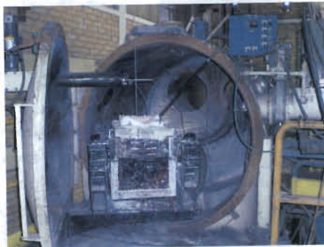
Figura 3.3. Proceso de fundición de los elementos de aleación en el horno
