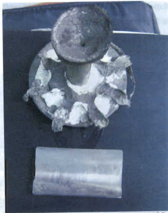
Figura 3.6. Placa obtenida por corte por chorro de agua y árbol de vaciado
