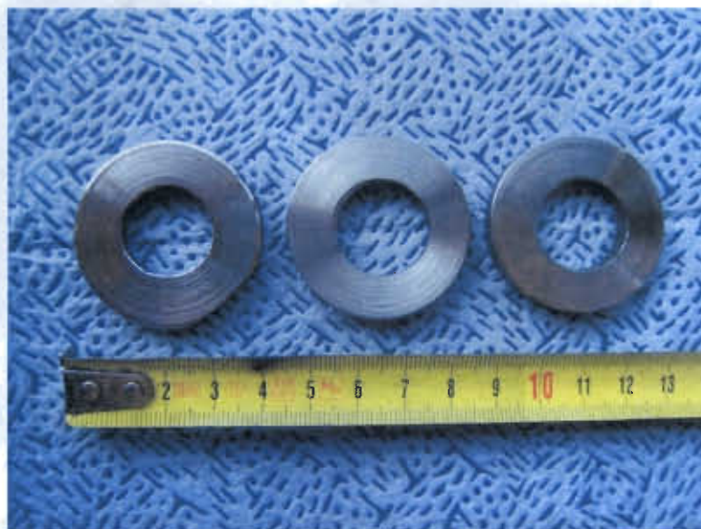
Figura 3.8. Fotografía de los anillos después del maquinado
