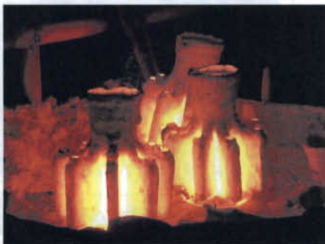
Figura 3.5. Solidificación del material fundido dentro de los moldes
