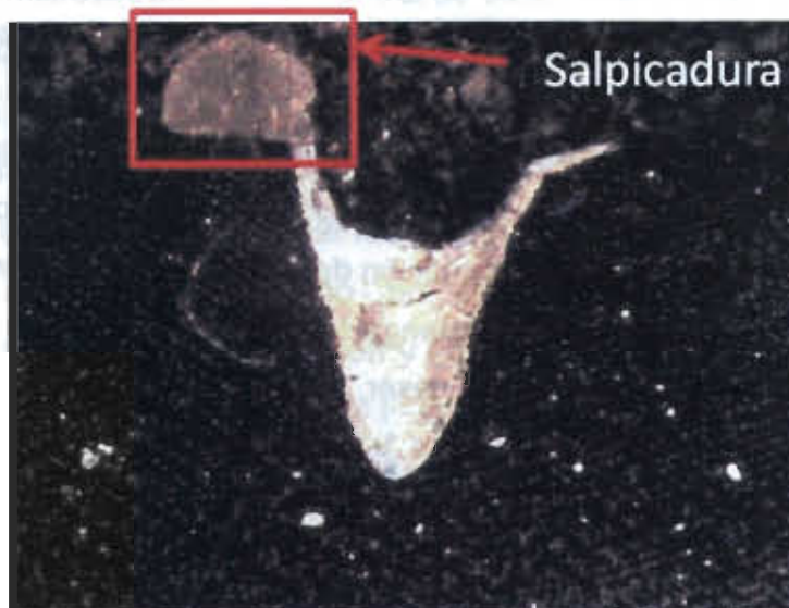
Figura 2.36. Espectrometría óptica de un tratamiento superficial con láser que presenta salpicaduras.
