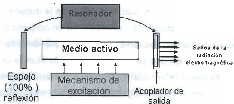
Figura 2.7. Componentes básicos de un láser
