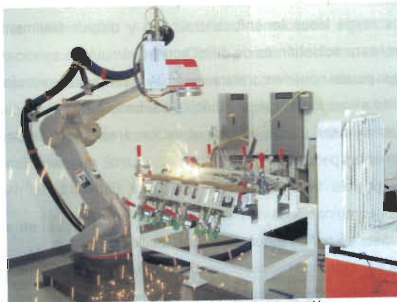
Figura 2.8. Proceso de soldadura por rayo láser
