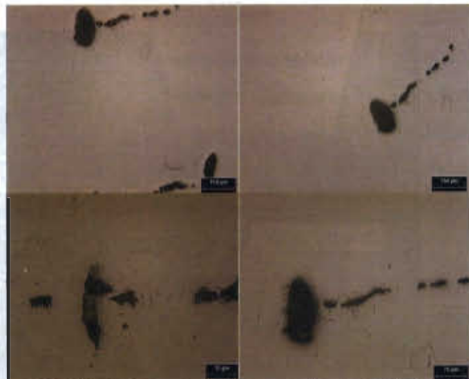
Figura 4.27. Defectos superficiales encontrados en la muestra 27
