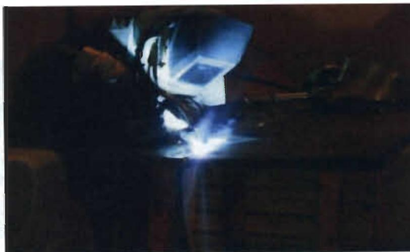
**Figura 3.6** Realizando la reparación de una de las probetas de prueba
