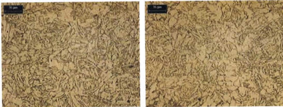
**Figura 4.2.** Microestructura de la ZAC en muestras sin reparación y con una reparación, respectivamente (Nital 5%) 200X.
