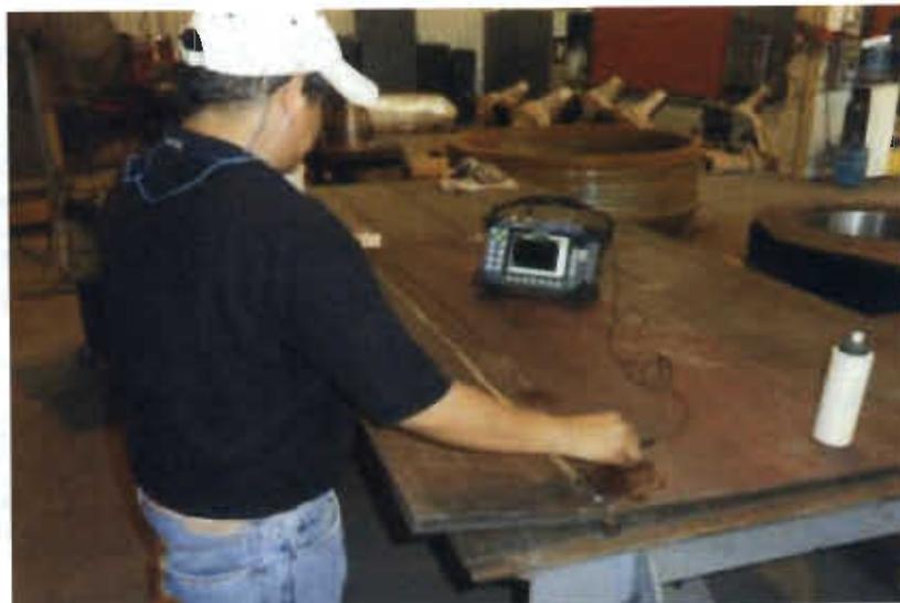
**Figura 3.4** Inspección por ultrasonido en las probetas de prueba
