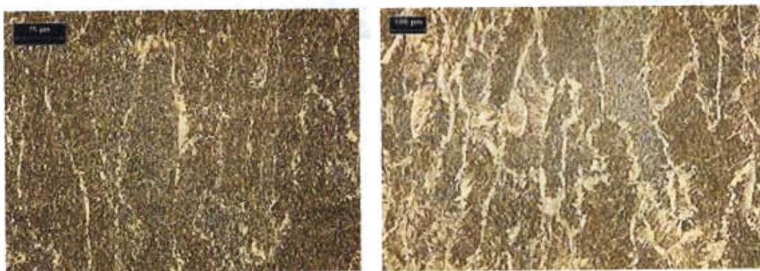
**Figura 4.6.** Microestructura del metal de soldadura, probetas sin reparación y con una reparación, respectivamente (Nital 5%) 50X.
