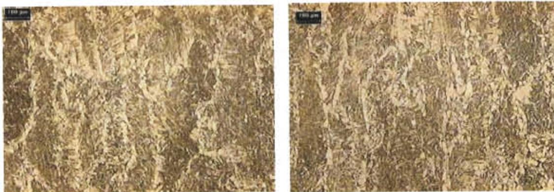
**Figura 4.7.** Microestructura del metal de soldadura, probetas con dos y tres reparaciones, respectivamente (Nital 5%) 50X
