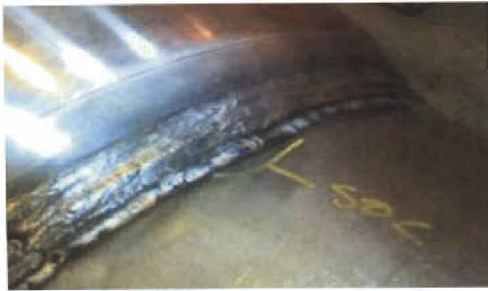
**Figura 2.14.** Discontinuidad por socavado
