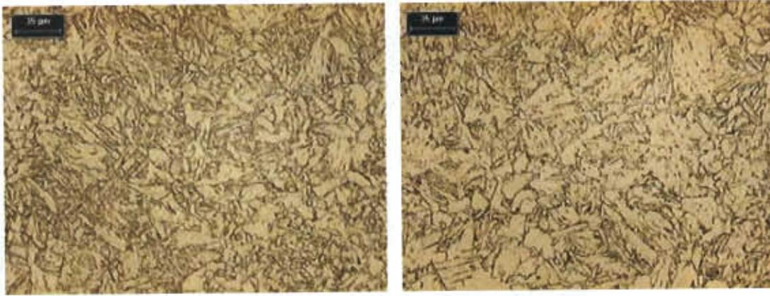
**Figura 4.3** Microestructura de la ZAC en muestras con dos y tres reparaciones, respectivamente (Nital 5%) 200X.
