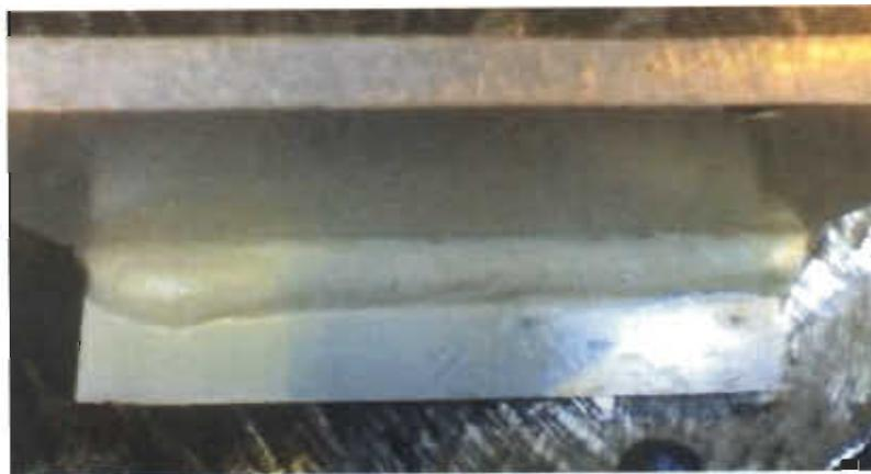
**Figura 2 .17** Defecto por convexidad en el cordón de soldadura
