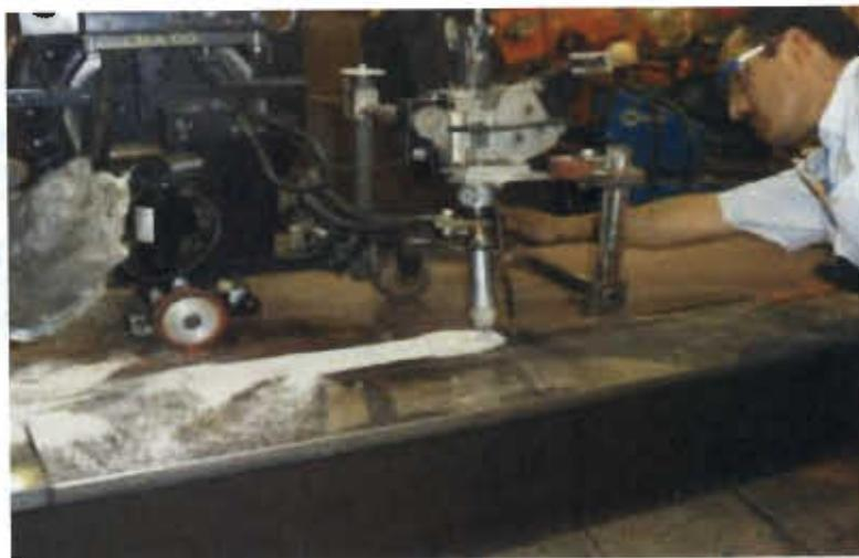
**Figura 3.3** Aplicación del arco sumergido en las probetas de prueba
