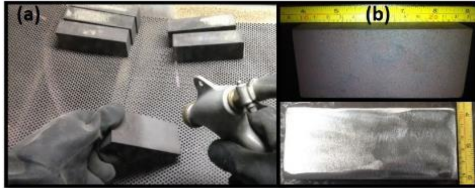
Figura 3.6. (a) Granallado y (b) desbastado de placas experimentales.
