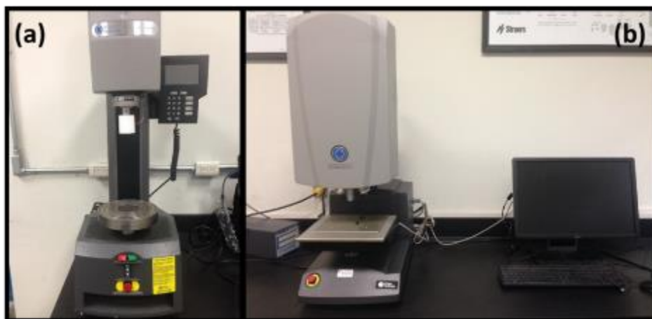
Figura 3.11. (a) Equipo Wilson Hardness ROCKWELL 2000 y (b) equipo de microdureza Vickers TUKON 2500.
