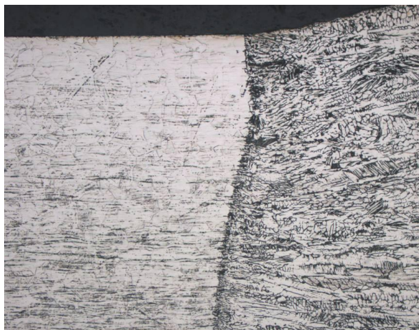
Figura 4.5. Microestructura en la zona fundida del acero 304L 100X.
