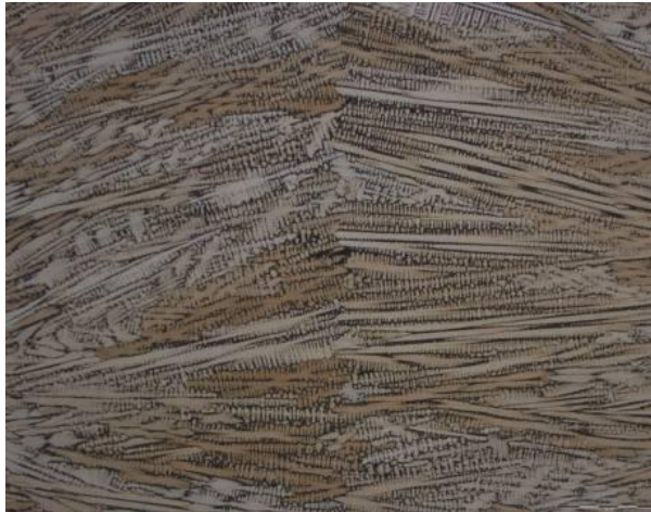
Figura 4.7. Microestructura en la zona fundida del acero TWIP 200X
