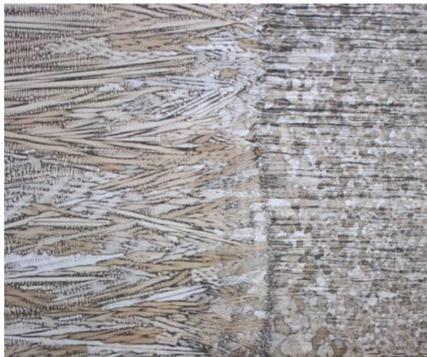
Figura 4.8 Microestructura en la línea de fusión del acero TWIP 200X
