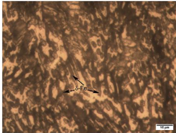
Figura 2.49. Corrosión interdendrítica en el botón de la soldadura. [23]
