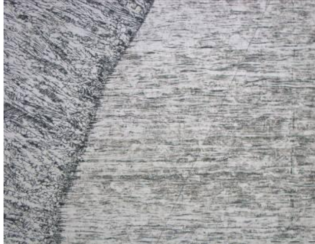
Figura 4.4. Microestructura en la línea de fusión del acero 304L con láser de Nd:YAG 100X
