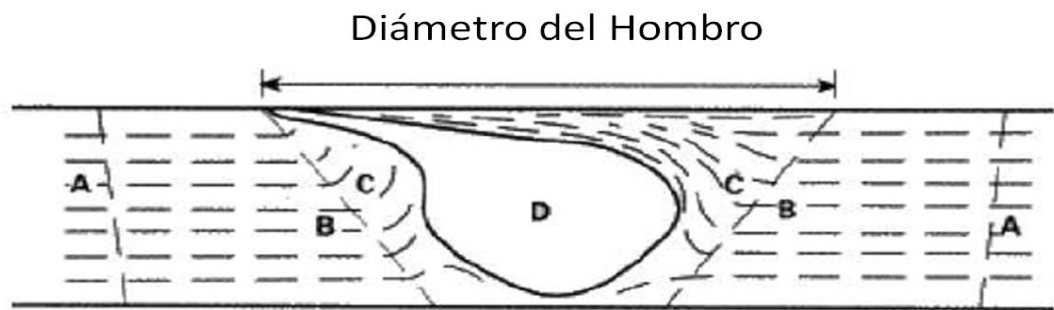
Figura 2.31. Regiones de una soldadura por Fricción agitación. A) Material Base, B) Zona afectada por el calor, C) Zona termo mecánicamente afectada, D) Botón de soldadura. [19]
