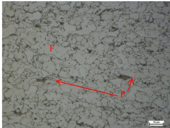
**Fig. 1.** Micrografías de material base API 5L X70. a)1000X.
