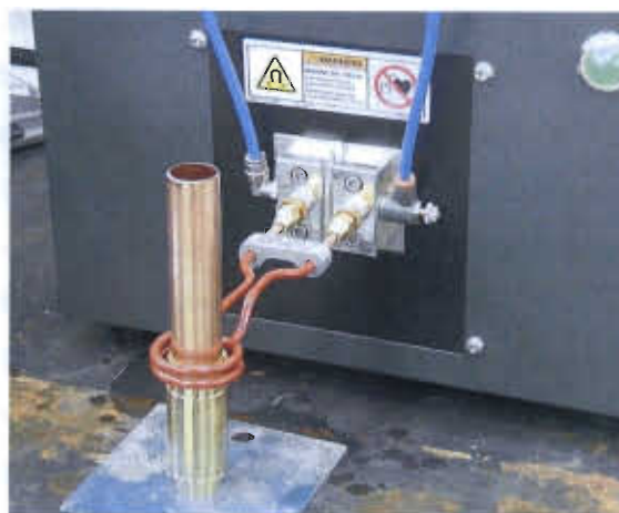
Figura 2.10 Unión entre un tubo de Cu y un accesorio de latón mediante brazing por inducción (9).
