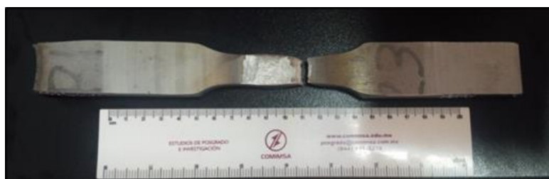
Figura 4. 11 Probeta de tensión de AID 2205 unida mediante GTAW con ruptura en MB.
