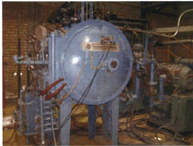
Figura 2.9. Horno de vacío para realizar el proceso brazing.
