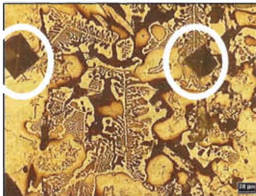
Figura 4.31. Imagen que muestra la indentación sobre la zona de difusión y el metal de aporte sobre un compuesto intermetálicos.
