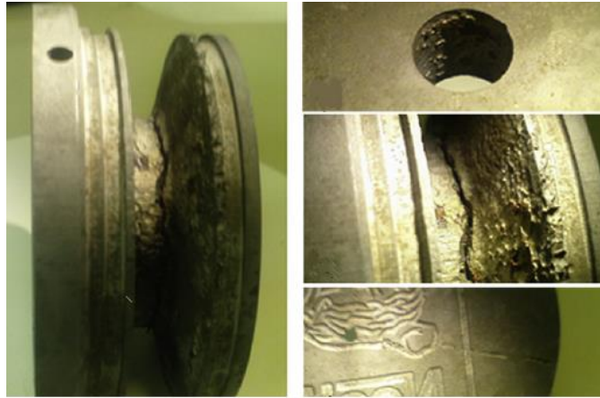
Fig. 22: Grieta en el espécimen producida por esfuerzos de expansión-compresión [29]
