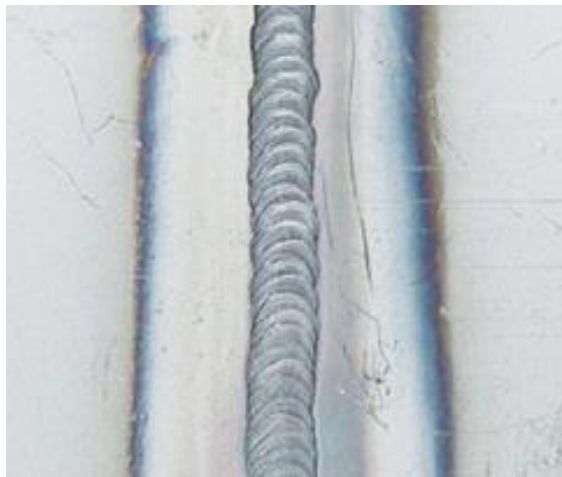
Fig. 4: Soldadura producida por arco pulsado [8]
