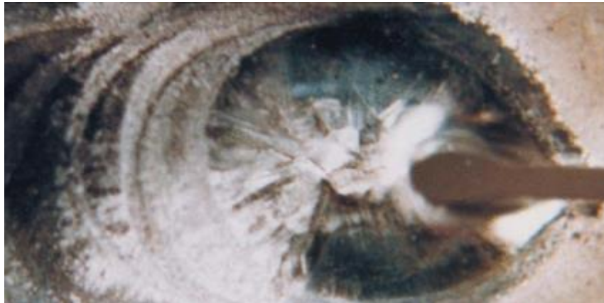
Fig. 13: Defecto identificado como cráter, según la literatura [13]
