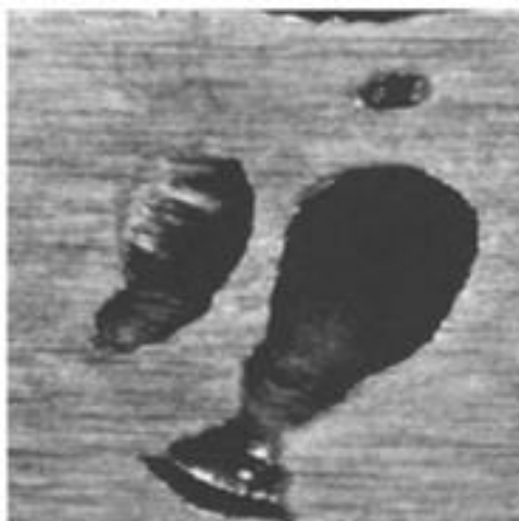
Fig. 17: Porosidad agujero de gusano, corte longitudinal 20x [13]
