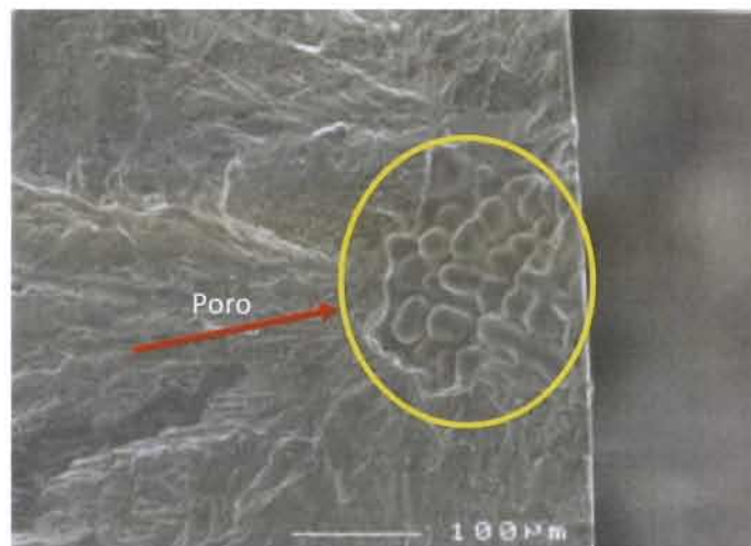
Figura 2.16 Porosidad en las aleaciones de fundición de Al-Si (17).
